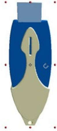
Attrapez une des poignées rouges et tâchez de tourner votre composition 3D. L'avantage des poignées est de restreindre la rotation sur des axes. Avec un peu d'entraînement le résultat est plus facile à prévoir. Il faut tourner la clé pour présenter le côté droit ou gauche face à l'écran. De plus il faut mettre l'objet bien à l'horizontale pour que le déplacement vertical à l'écran d'une partie corresponde à l'axe vertical (**Z**) de la composition 3D.
